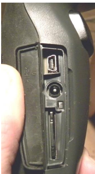
Kuva 3. USB-kaapelin ja latauspistokkeen kiinnityspaikat sekä muistikortti.
