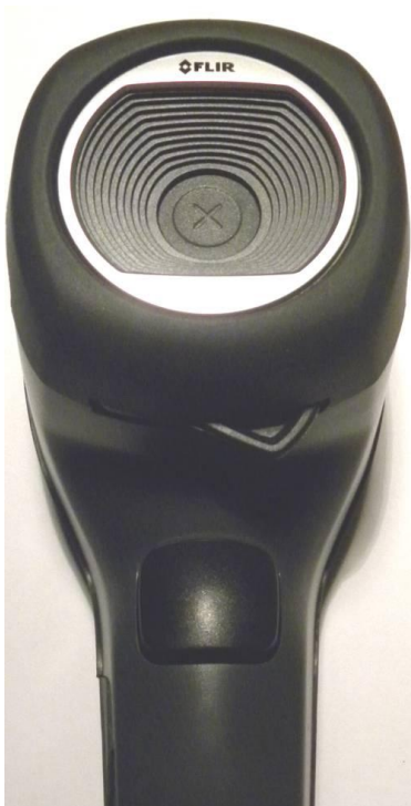
Kuva 1. Linssisuoja, linssisuojan avaus- ja sulkuvipu sekä kuvanottopainike
